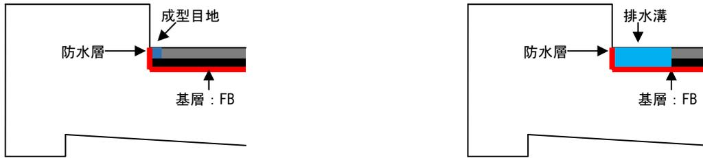
図 3.4.1 耐久性向上に配慮した一事例（左：舗装端部処理，右：舗装端部排水溝）
