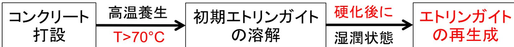
→内部の膨張圧によりひび割れが発生
