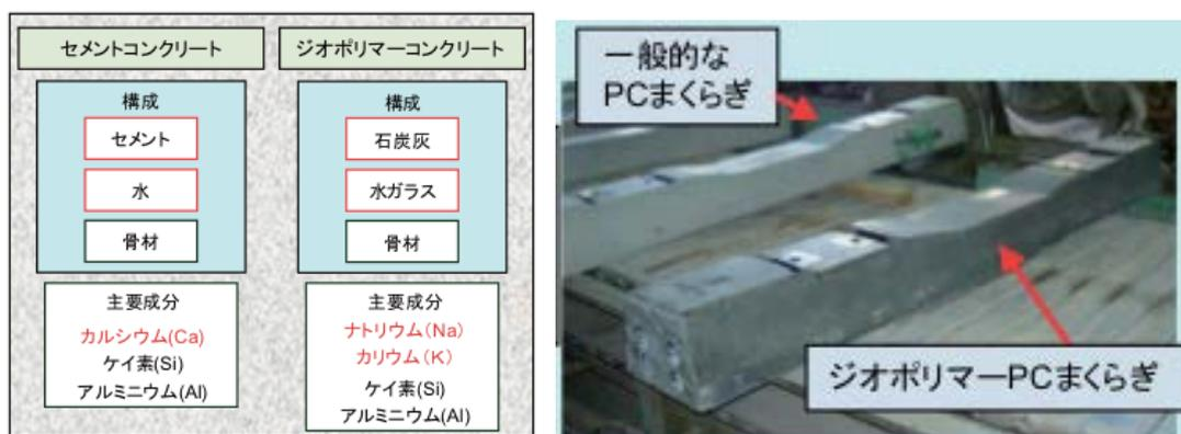
図 4.3.2 ジオポリマーコンクリートの使用材料と製品一例<sup>16)</sup>
