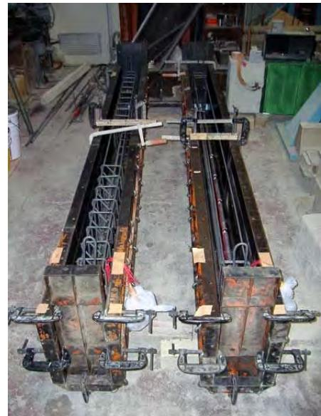
写真3.3.2 型枠への設置
