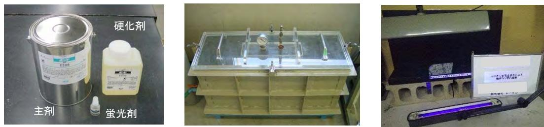
写真4.4.6 蛍光エポキシ樹脂含浸法による微細ひび割れ観察要領
