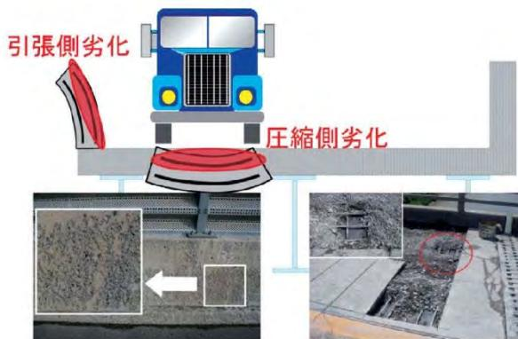
図 4.2.4 壁高欄および道路橋床版の凍害による劣化状況<sup>3)</sup>
