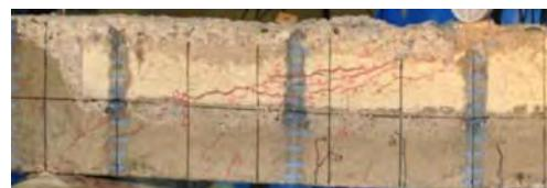
写真-3 最大荷重時の損傷状況（供試体C10）
