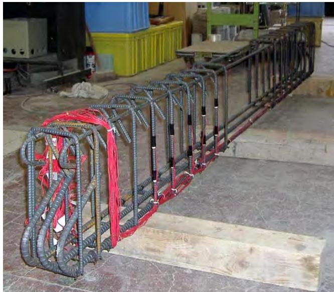
写真3.3.1 鉄筋の組立て
