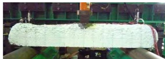
写真-1 載荷試験状況
