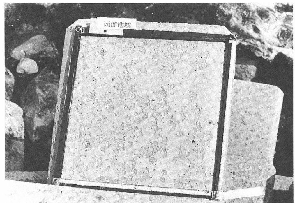
写真2 消波ブロック（D=2.10mm）
