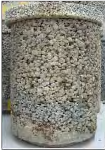
写真 4-4 ポーラスコンクリートと中詰 BT ソイル
