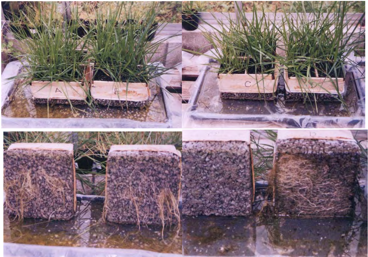
写真 3-2 ポーラスコンクリートへの植生 (A, B: 廃ガラスリサイクルブロック (セメント量少), C: 廃ガラスリサイクルブロック (セメント量多), D: 普通ポーラスコンクリート)
