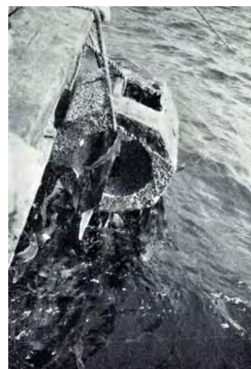
写真 1-5 投入 10 ヶ月 後のブロック 上部に横転し砂中に埋没した 痕跡が見える (昭和 35 年 10 月戸井村)
