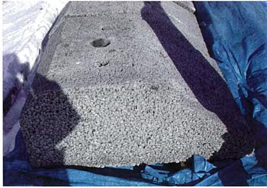
写真 4. 2. 3 ポーラスコンクリートブロック(一般部)
