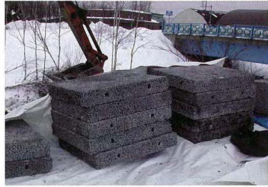
写真 4. 2. 4 ポーラスコンクリートブロック(河床部)
