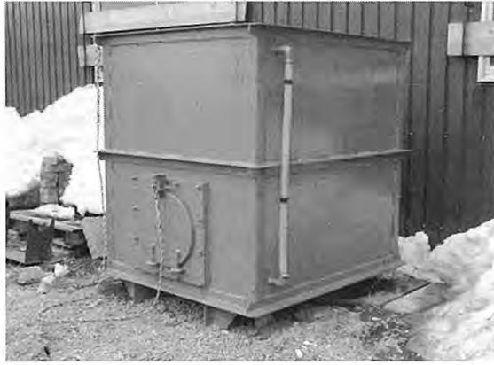
写真 3.2.9 変水位透水試験装置(透水管用)
