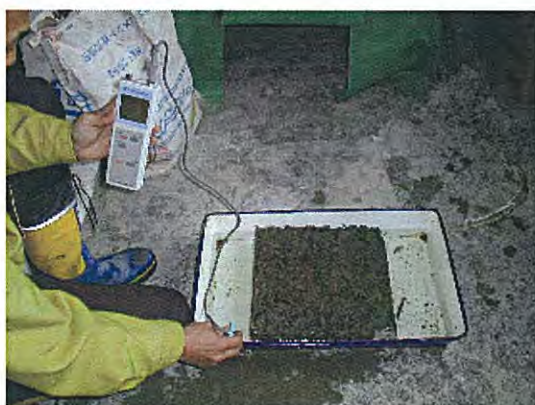
写真 4-7 供試体断面溶出 pH測定状況
