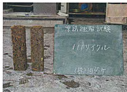
写真 4-11 凍結融解試験（融解時）
