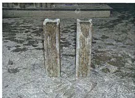
写真 4-10 凍結融解試験（凍結時）
