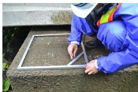
写真4.4.5 剥離度算出のための剥離深さ測定状況
