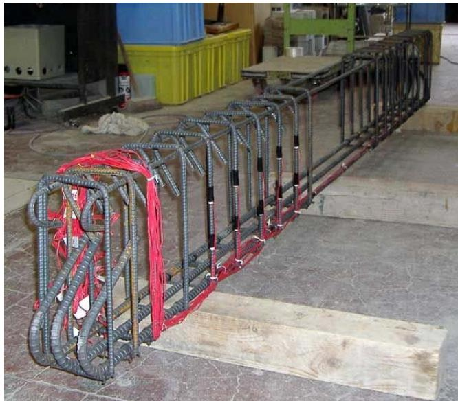
写真3.3.1 鉄筋の組立て
