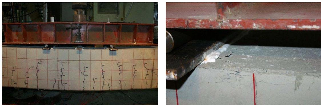
写真 3.3.9 曲げ破壊型供試体の実験終了後の損傷状況
