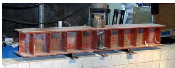
写真 3.3.8 二点集中荷重の載荷方法
