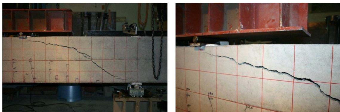
写真 3.3.10 せん断補強鉄筋の無いせん断破壊型供試体の実験終了後の損傷状況
