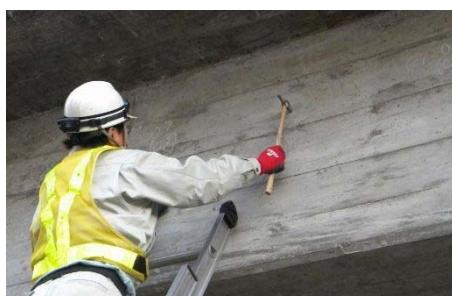
写真 4.4.1 打音法によるたたき調査状況
