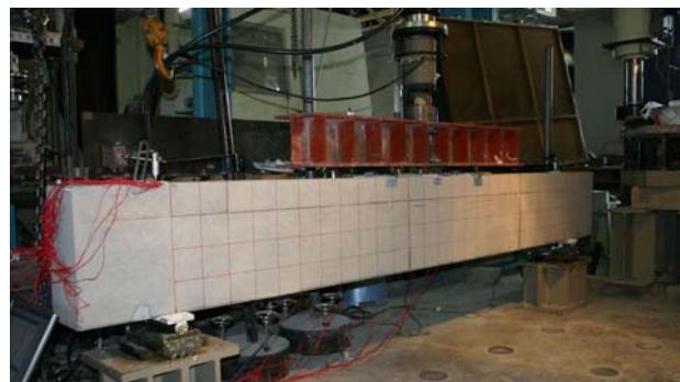
写真-1 静的載荷実験の状況
