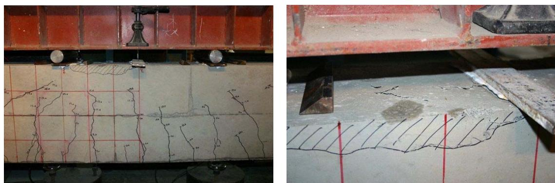
写真 3.3.11 せん断補強鉄筋を有するせん断破壊型供試体の実験終了後の損傷状況
