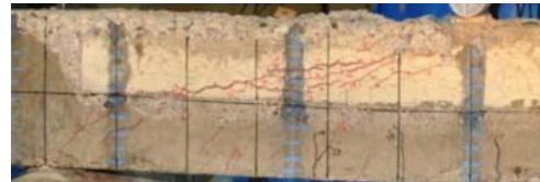
写真-3 最大荷重時の損傷状況（供試体C10）
