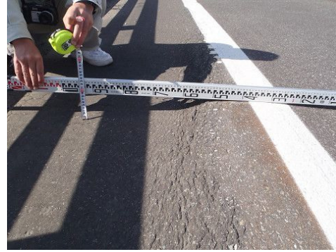
写一解 2.4.7 路面凹凸の例
