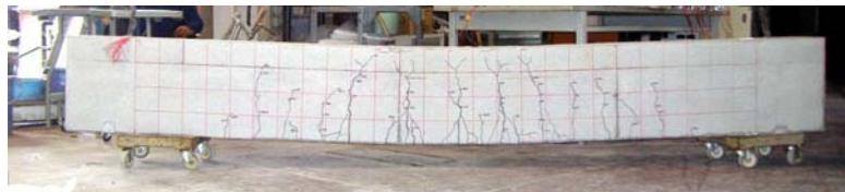
写真3.3.9 曲げ破壊型供試体の実験終了後の損傷状況
