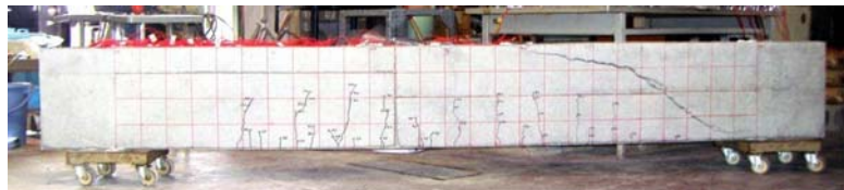
写真3.3.10 せん断補強鉄筋の無いせん断破壊型供試体の実験終了後の損傷状況
